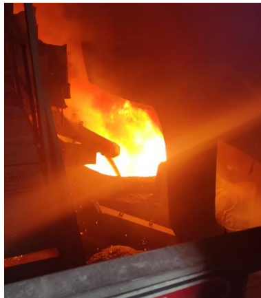
Figura 3.- Adición de ferroaleaciones.
