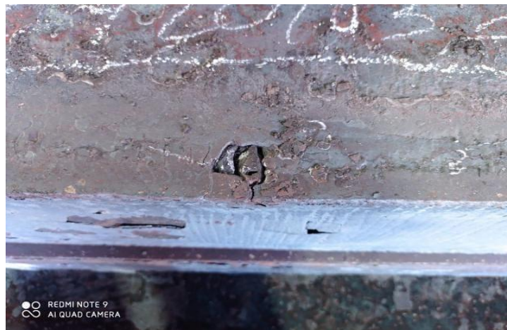
Figura 9.- Escoria atrapada en cara superior de planchón.
