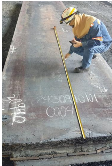
Figura 14.- Medición dimensional de planchón.
