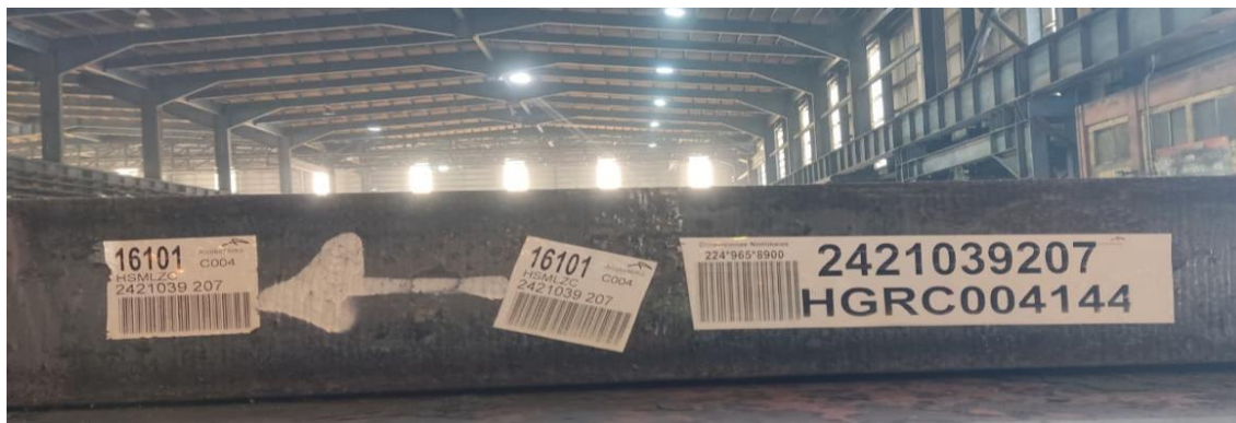
Figura 17.- Marca de orientación de carga del planchón.
