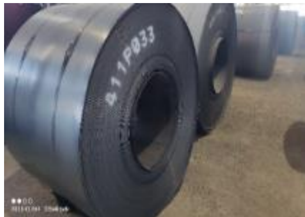
Figura 19.- Rollo de acero inspeccionado.
