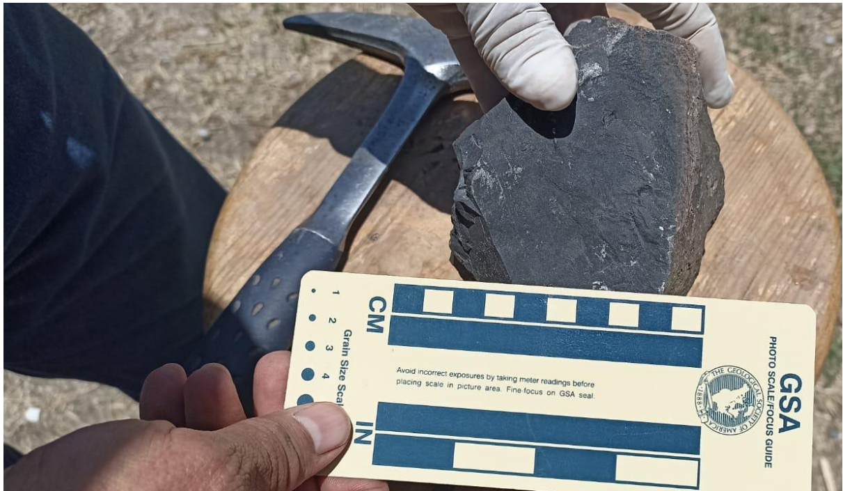
Figura 13: Se observa la roca que cortaremos para su posterior tratamiento en la creación de una lámina delgada.
