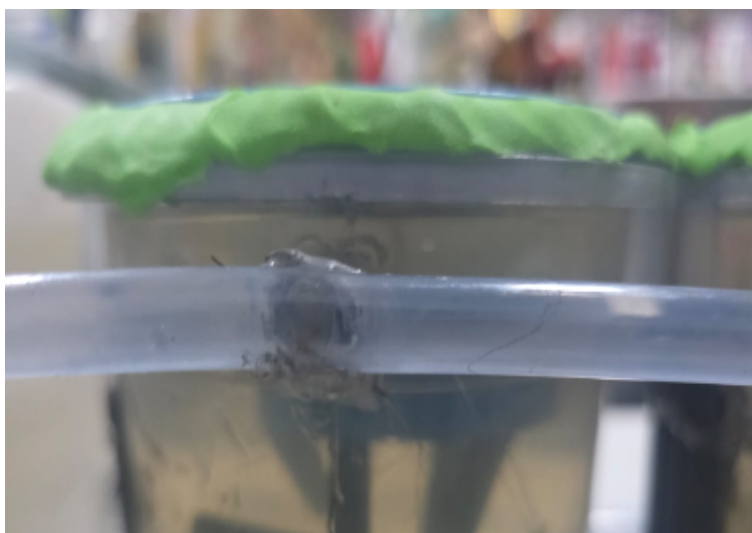
Figura 4.1: Nivel no optimo de sustrato en la CCM1.
