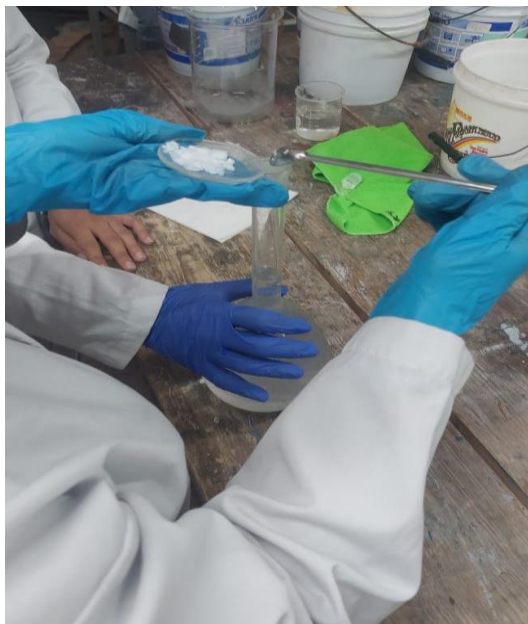
Figura 5. Preparación de solución alcalina de NaOH 2.5 M.
