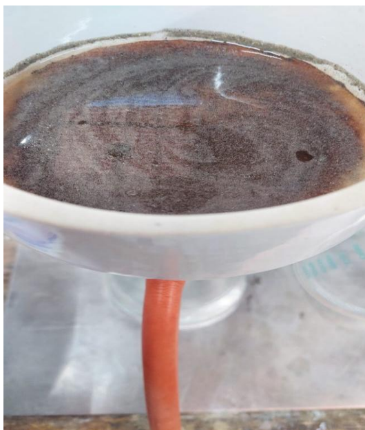
Figura 7. Precipitado de color marrón retenido en el papel filtro.
