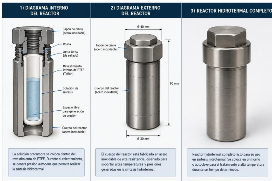
Figura 1.4 1) Diagrama interno del reactor. 2) Diagrama externo del reactor. 3) Reactor Hidrotermal [36].
