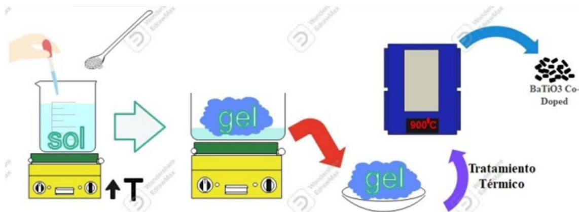
Figura 1.2 Ruta de síntesis de materiales tipo ABX_3 por el método del precursor polimérico (Pechini), fuente: elaboración propia (EdrawMax software).
