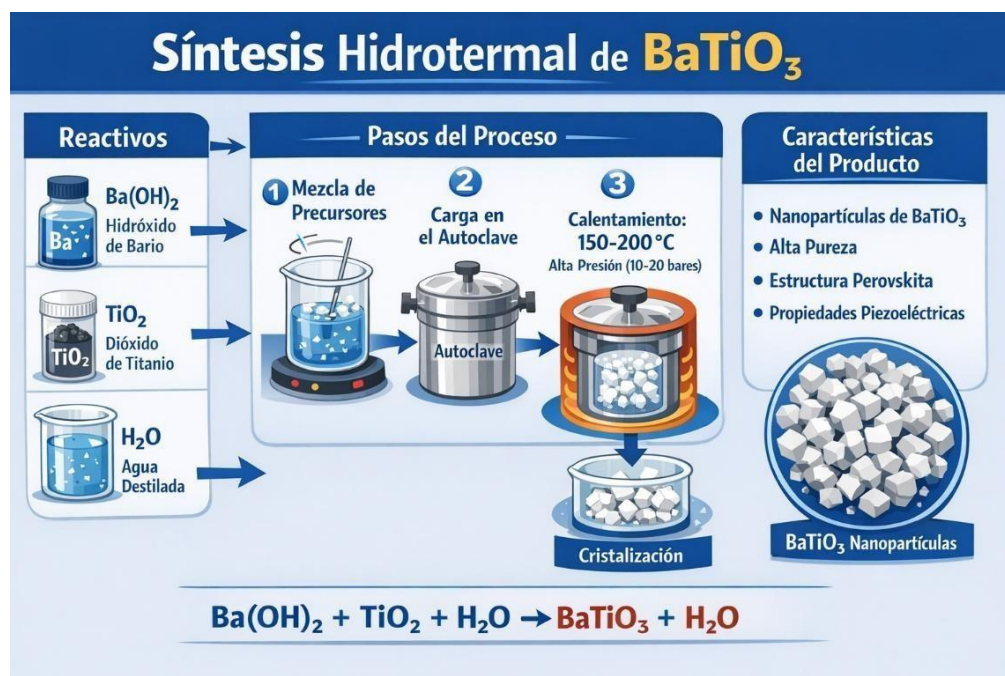
Figura 1.3 Proceso de síntesis hidrotermal de BaTiO 3 : etapas, condiciones de reacción y características del cerámico final; fuente: elaboración propia (Inteligencia Artificial).
