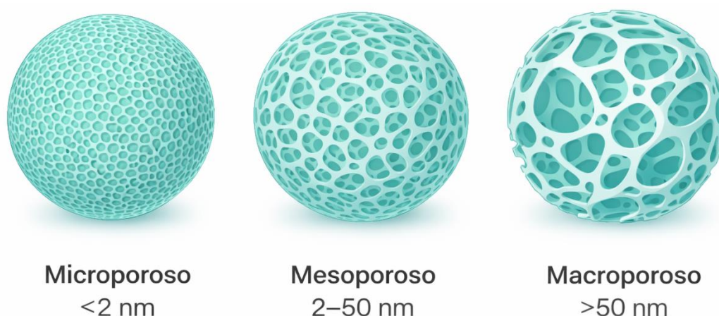
Figura 2.5 Clasificación de los materiales según el tamaño de sus poros.
