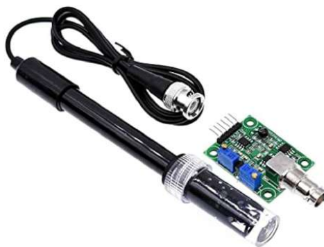
Figura 4.20: Sonda de pH E-201-9 y módulo acondicionador PH4502-C instalados en el prototipo. Fuente: Elaboración propia.
