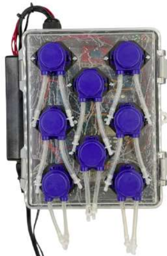
Figura 5.23: Integración de las bombas peristálticas para el suministro de agua a cada planta. Fuente: Elaboración propia.
