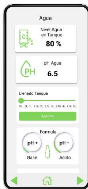
Figura 5.38: Monitoreo de pH y nivel de tanque.
