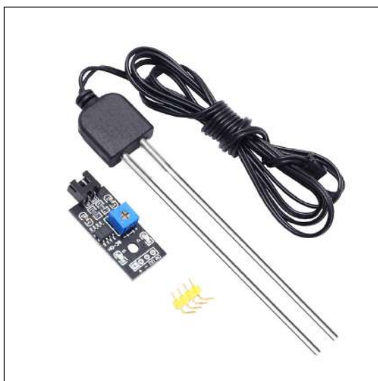
Figura 4.9: Sensor de humedad FC-28. Fuente: Elaboración propia.
