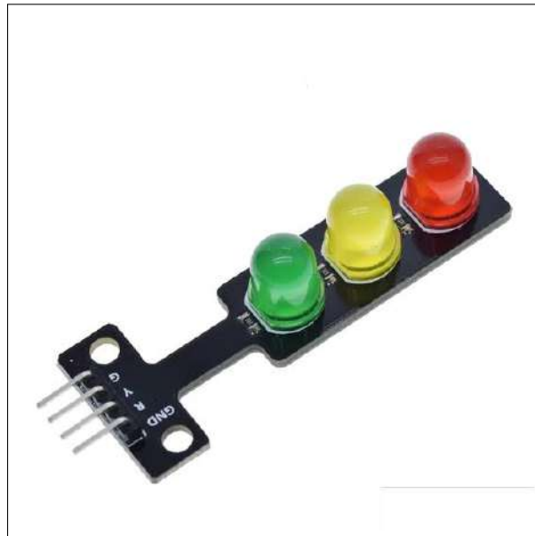
Figura 4.17: LEDs indicadores del estado general de humedad del sistema. Fuente: Elaboración propia.
