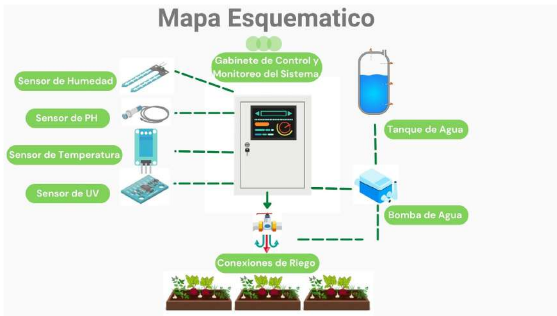
Figura 4.6: Mapa esquemático del prototipo mostrando la distribución de componentes. Fuente: Elaboración propia.
