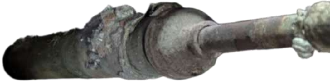
Figura 38. Lanza de grafito propuesta utilizada en el proceso de desgasificación.
