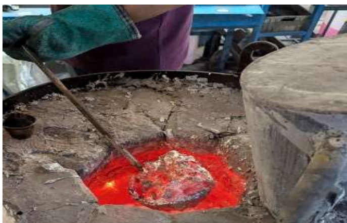
Figura 26. Desescoriado del baño metálico utilizando cuchara perforada.
