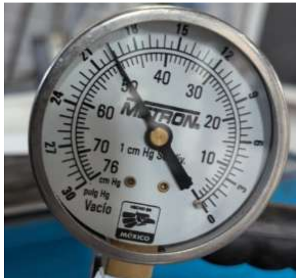
Figura 33. Lectura de la presión de vacío, ejecutada en la prueba de vacío.
