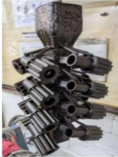
Figura 11. Árbol de fundición.
