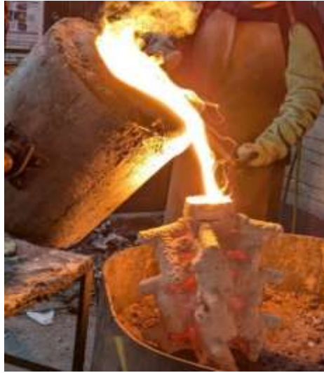
Figura 16. Vaciado del baño metálico al molde cerámico.
