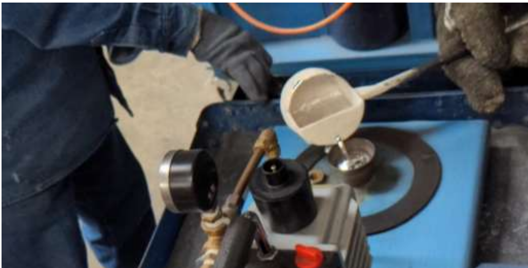
Figura 27. Toma de muestra del aluminio líquido para prueba de vacío.
