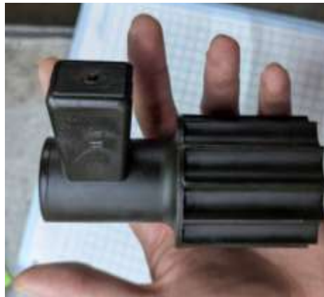
Figura 10. Modelo de cera conectada a colada de cera.
