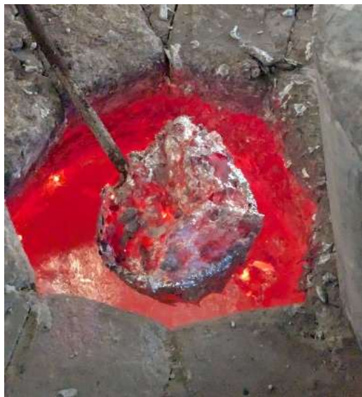
Figura 36. Desescoriado post tratamiento de desgasificación.
