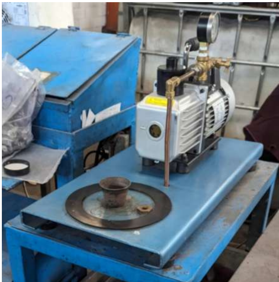
Figura 37. Aplicación de la prueba Straube-Pfeiffer.
