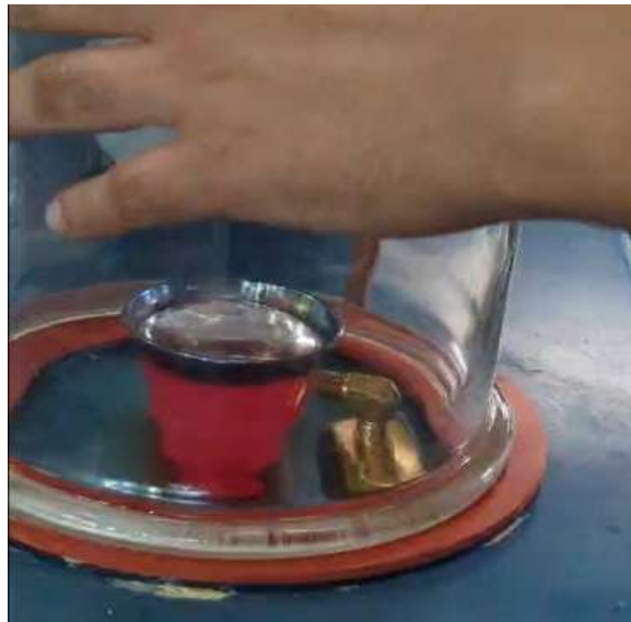
Figura 32. Probetero colocado en la estación de vacío para la prueba de Straube-Pfeiffer.
