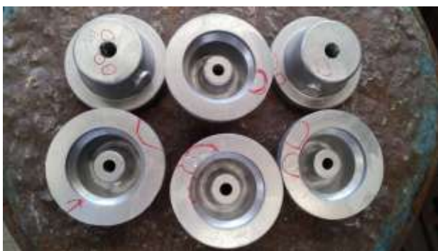
Figura 21. Material de retorno de aluminio A356: Piezas rechazadas por defectos superficiales.
