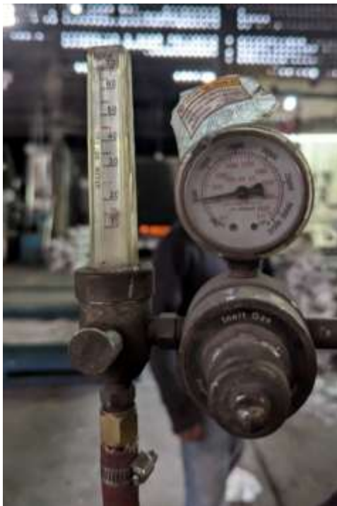
Figura 34. Lectura del manómetro ajustada a 15 psi.
