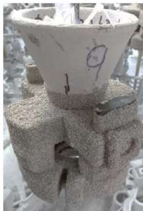
Figura 13. Curado de las capas cerámicas (Morales Ramírez, 2023).
