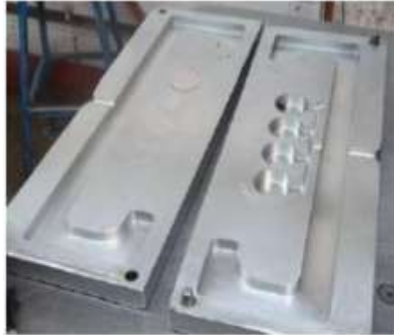
Figura 8. Molde maestro de aluminio (Morales Ramírez, 2023).
