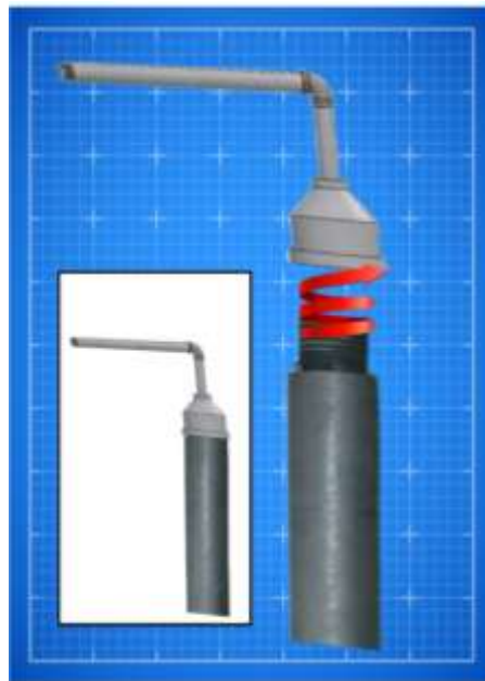
Fig. 20 Diseño de conexión en “L” para uso de lanza de grafito.
