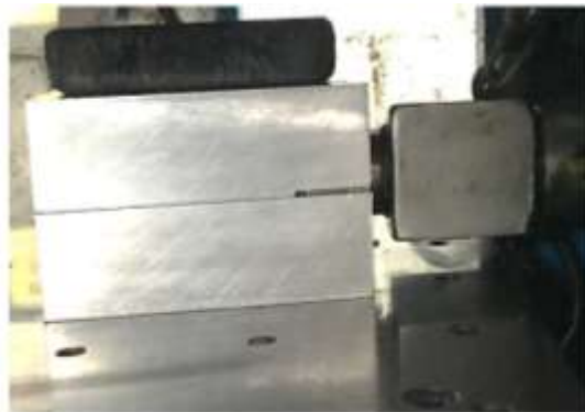
Figura 9. Proceso de inyección de cera en molde de aluminio (Morales Ramírez, 2023).
