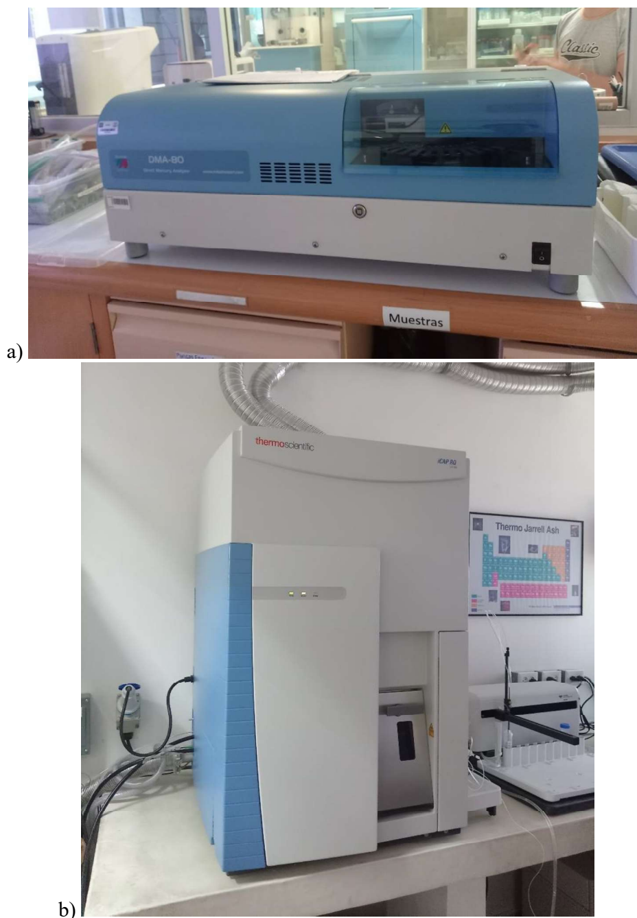
Fig. 5.3 Equipos analíticos utilizados en el laboratorio de Geofísica de la UNAM: a) analizador directo de mercurio DMA-80 y b) ICP-MS modelo iCAP Qc, empleado para análisis multielemental a niveles traza.
