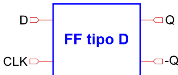
Fig. 6 Símbolo del Flip-Flop D.
