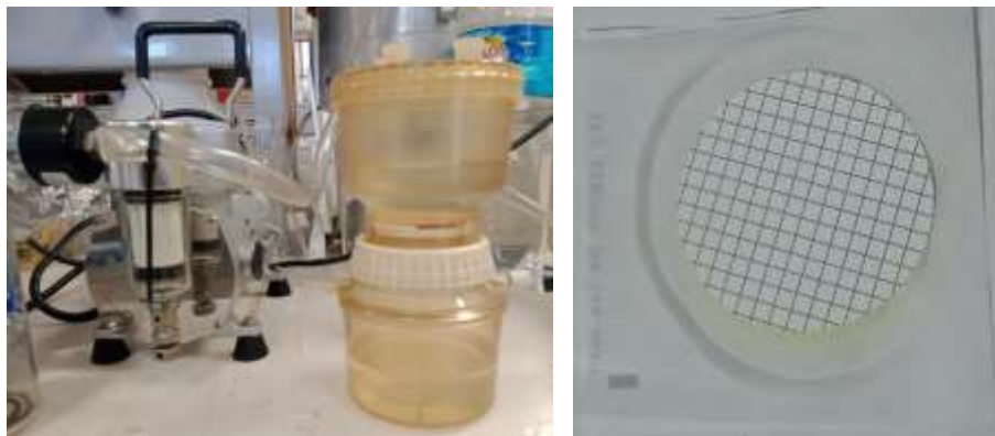
Figura 4. Bomba de filtración al vacío y filtro estéril de 0.45 \mu\text{m} en 47 mm de diámetro de nitrato celulosa utilizados para filtrar los químicos y las muestras extraídas de Apis mellifera de microplásticos
