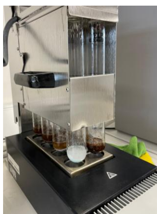
Figura 21. Muestras colocadas en el digestor.
