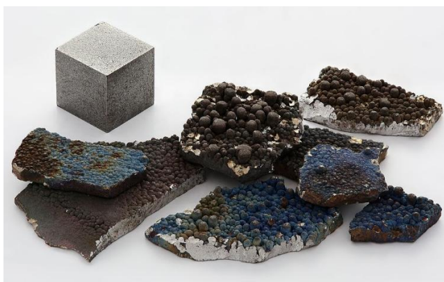
Figura 1 - Fragmentos de manganeso puro (99.99 %) refinado electrolíticamente, con superficies parcialmente oxidadas, junto a un cubo de 1 cm 3 de manganeso de alta pureza (99.99 %). Fuente: Alchemist-hp, 2010, Wikimedia Commons.
