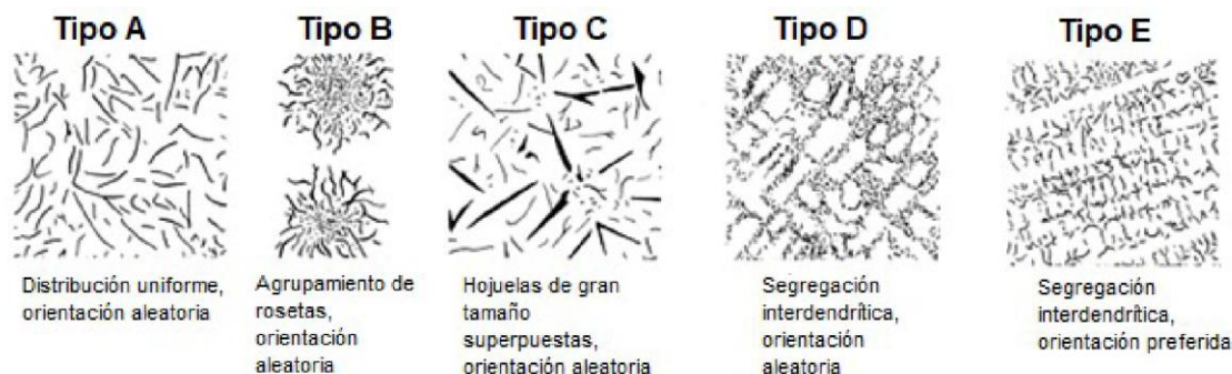
Figura 4. Tipos de hojuelas de grafito en hierro gris acorde a la AFS-ASTM, microestructuras a una amplificación de 100X [7].
