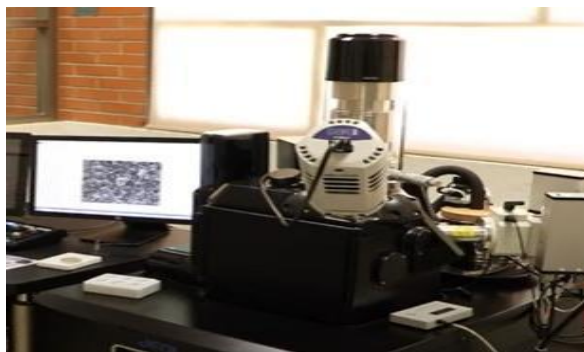
Figura 32. Microscopio electrónico de barrido marca JEOL IT 300.
