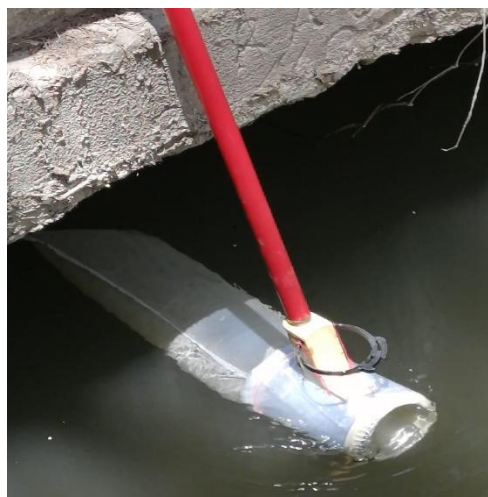
Figura 18. Muestreador de microplásticos utilizado en los canales de riego de la RBBM.
