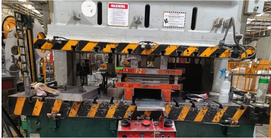
Imagen 8 Falta de orden y limpieza en la prensa. Fuente: Elaboración propia.
