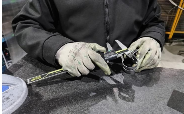
Imagen 27 Liberación de 1er pieza, toma de medidas con calibrador. Fuente: Elaboración propia.
