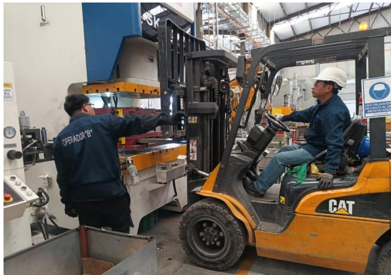
Imagen 14 Subir y alinear el troquel en la prensa. Fuente: Elaboración propia.
