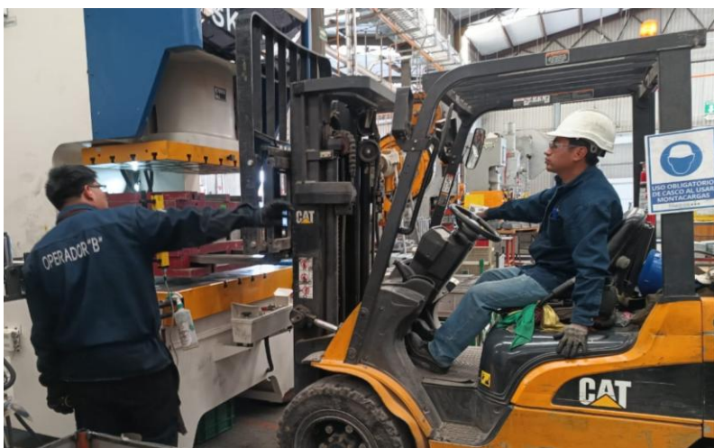
Imagen 24 Alinear el troquel entre el montador y el montacargarguista. Elaboración propia.
