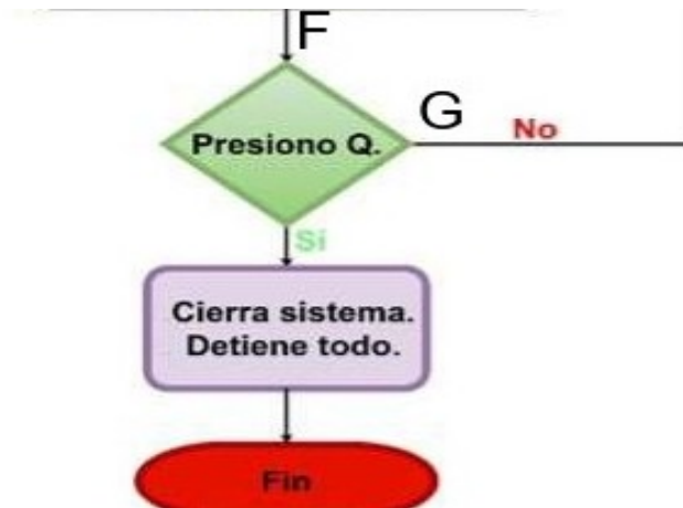
Figura 3.15. Finalización total del sistema.
