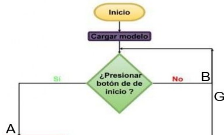
Figura 3.12. Parte de inicio del sistema.
