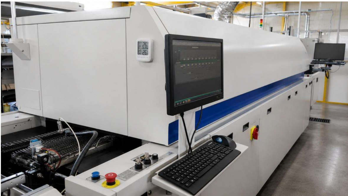
Figura 44. Horno de reflujo.
