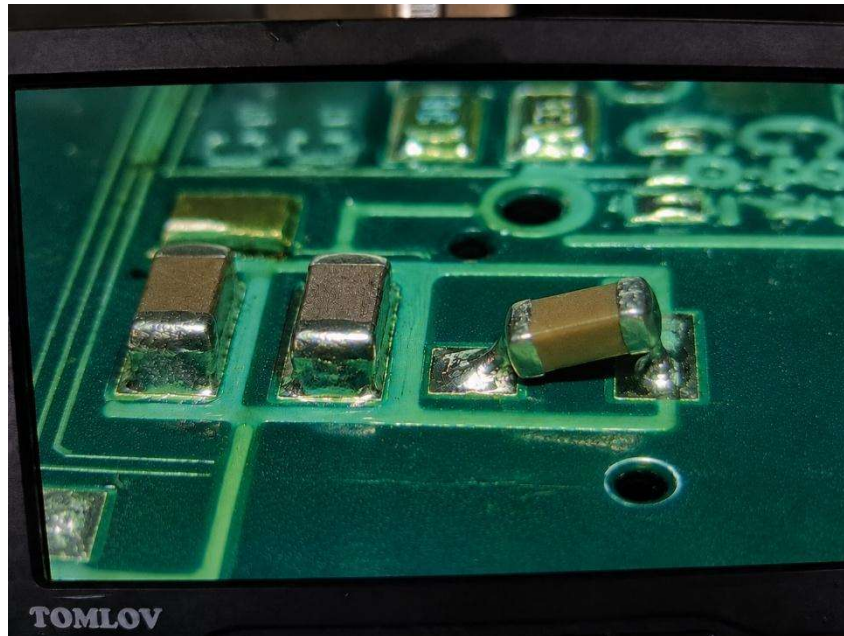
Figura 46. Imagen tomada de microscopio (defecto Tombstoning en un circuito).
