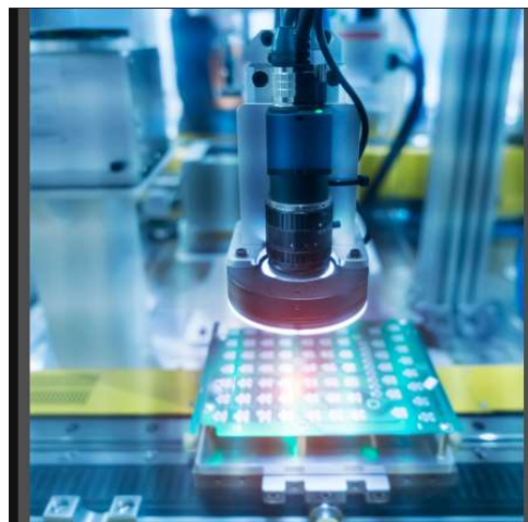
Figura 35. Cámara de visión artificial utilizada en AOI [32].
