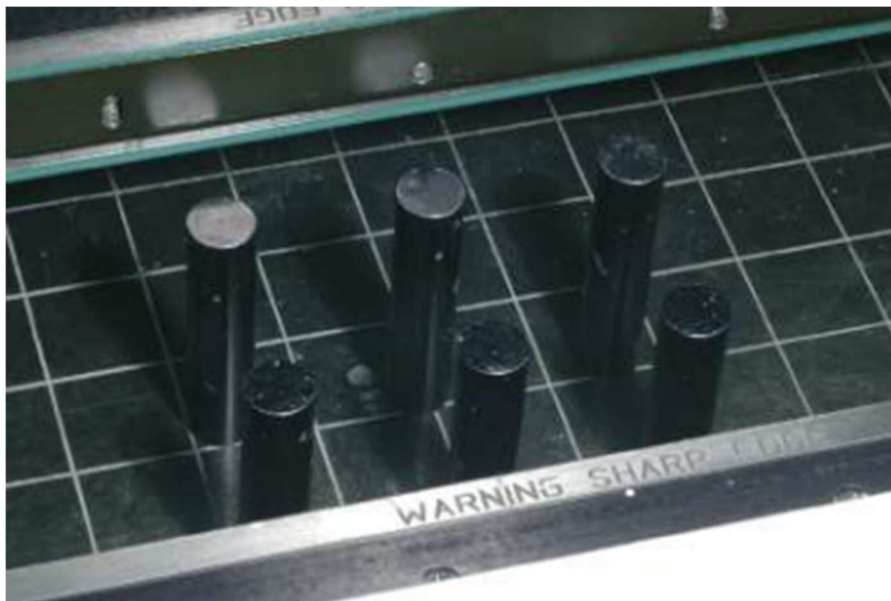
Figura 27. Pines de soporte para PCB.
