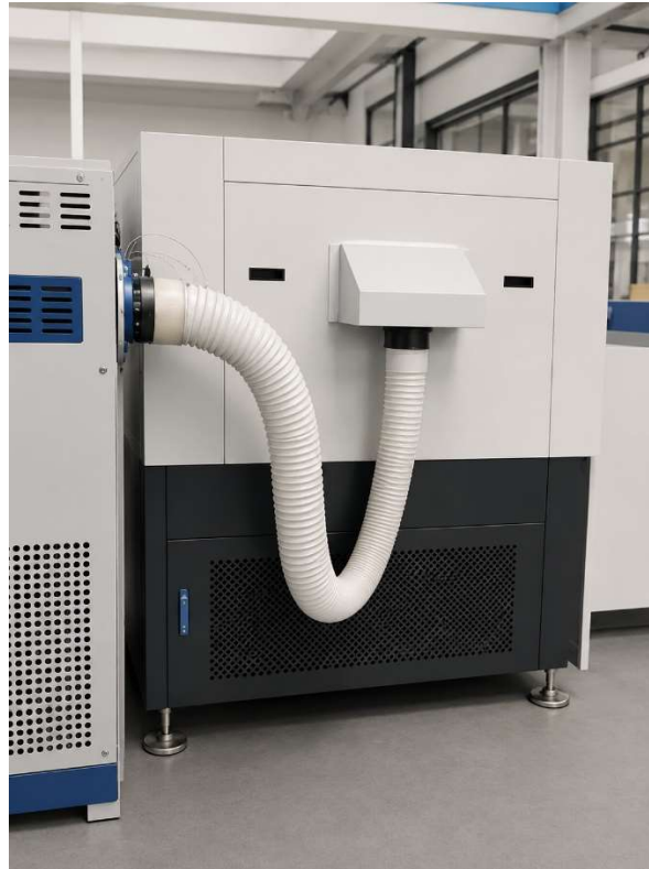
Figura 66. Climatizador de pasta conectada a máquina empastadora.
