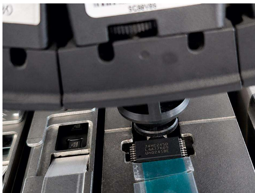
Figura 73. Ajuste de presión de boquilla en levantamiento de componente.
