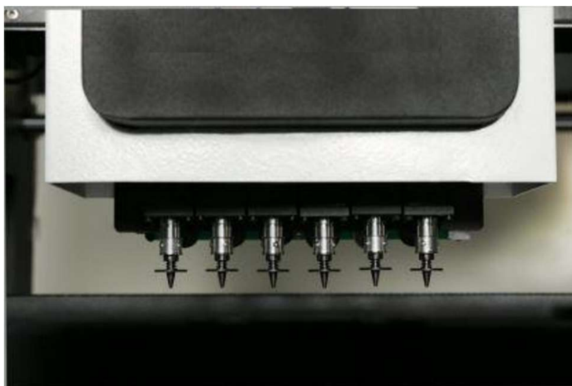
Figura 33. 6 boquillas de vacío en 6 cabezales - NeoDen7 [30].
