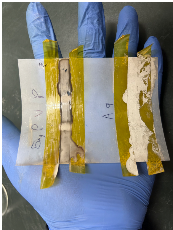
Figura 4.14: Tinta de nanoláminas de plata, del lado izquierdo con PVP y del lado derecho sin PVP, después del proceso de mezclado, depositado y secado sobre sustrato PET.
