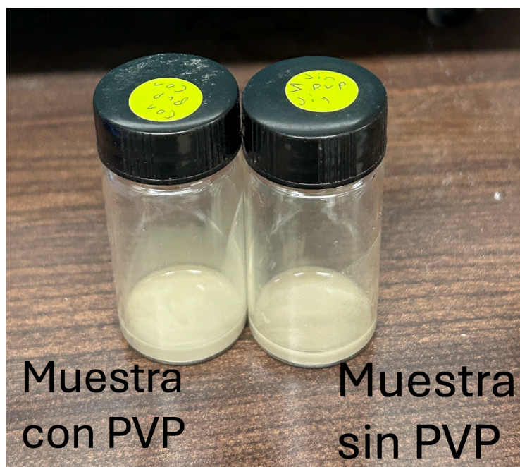
Figura 4.12: Tinta de nanoláminas de plata, del lado izquierdo con PVP en proporción 60/120/20/1 y del lado derecho sin PVP en proporción 3/6/1 antes del proceso de mezclado.
