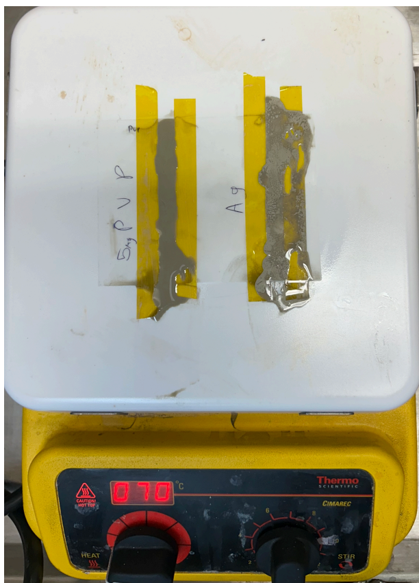
Figura 4.13: Tinta de nanoláminas de plata, del lado izquierdo con PVP y del lado derecho sin PVP, durante el proceso de secado sobre sustrato PET.
