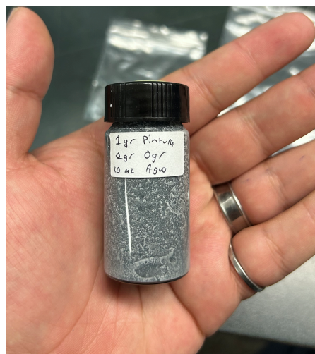
Figura 4.10: Resultado de la segunda muestra Politec/rGO proporción 1/1.
