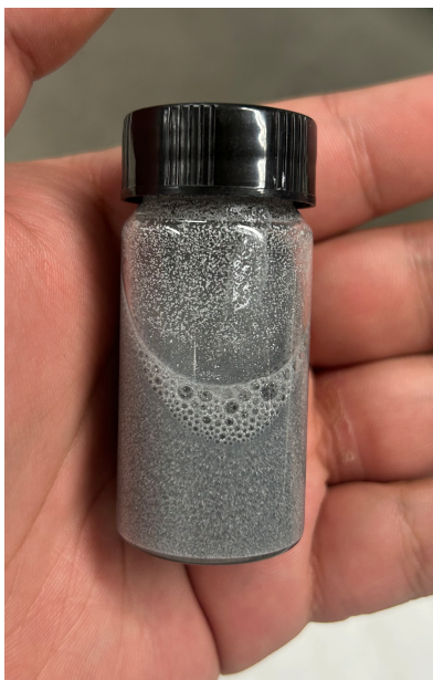
Figura 4.9: Resultado de la primera muestra de tinta Politec/rGO proporción 250/3.
