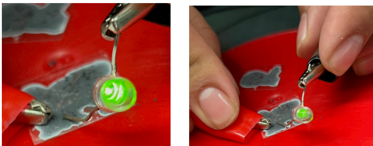
Figura 4.11: Encendido de un diodo LED con la segunda tinta muestra.
