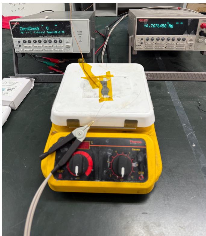
Figura 4.16: Ejemplo de la medición de resistencia de las tintas.
