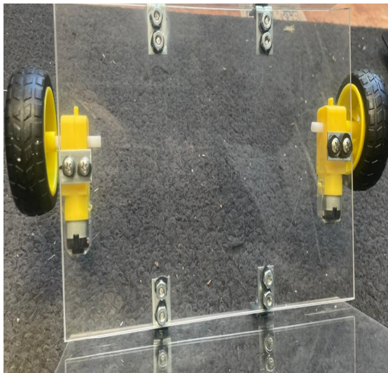
Figura 27. Perforaciones y ensamblaje de 4 lados y unión de motores con ruedas, (acrílico 25x15).
