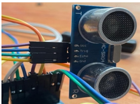
Figura 44. Conexión y análisis de control de colores del Sensor Ultrasónico (HC-SR04)
