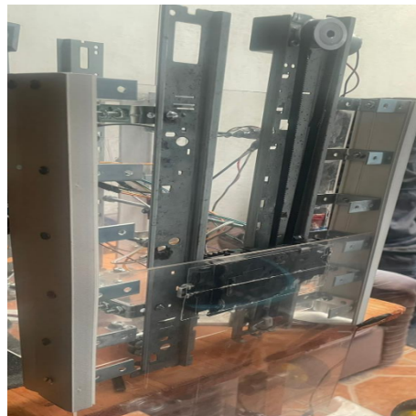
Figura 39. Ensamble de ménsulas y/o esquineros para el soporte y guía de desplazamiento de elevadores frontales y traseros.
