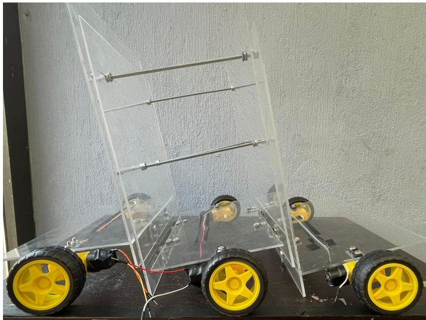
Figura 30. Resultado final del ensamblaje de las 4 varilla galvanizada de ½ pulgada, superior y media inferior.
