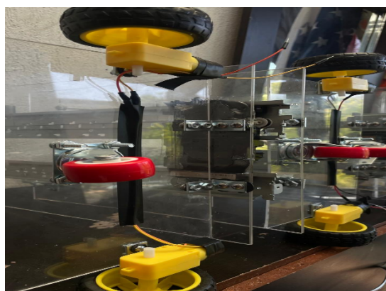
Figura 37. Ensamble de 3 ruedas deslizables y de carga de la estructura.
