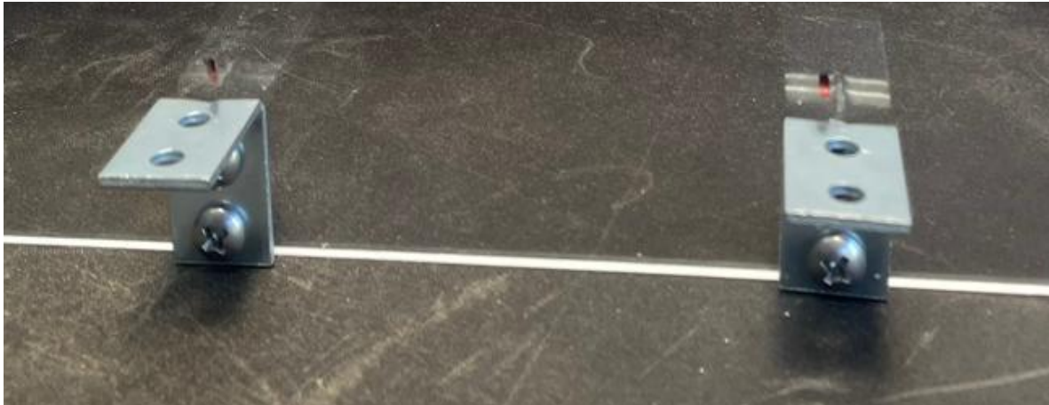
Figura 24. Perforaciones y ensamble de esquineros metálicos al acrílico de 25x30cm
