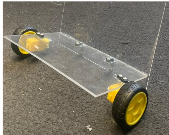
Figura 26. Perforaciones y ensamble de motores con ruedas, (acrílico 25x15).
