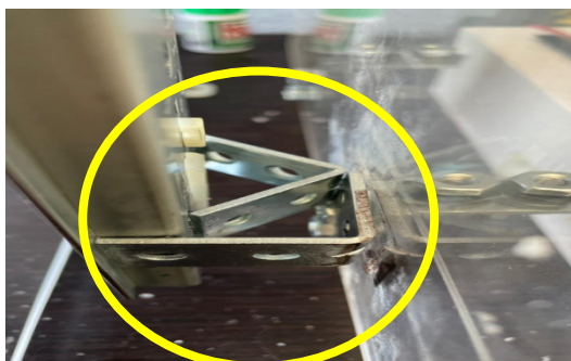
Figura 32. Ensamble de 2 ménsulas extras posicionadas en los 2 primeros lados laterales para soporte estable de la estructura.
