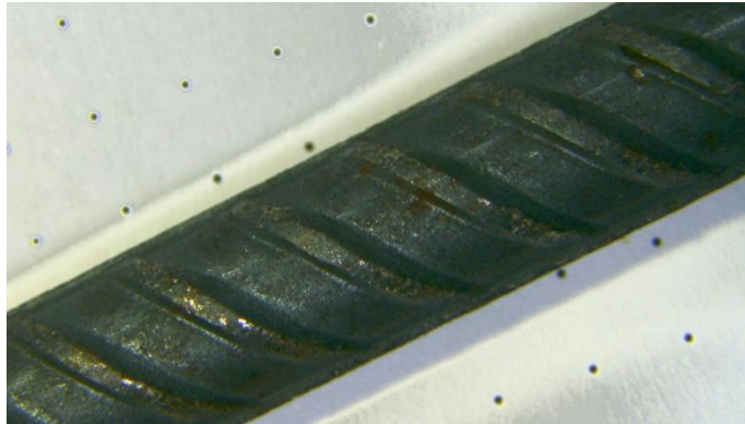
Figura 27. Varilla de acero corrugado sin recubrimiento antes de la exposición.
