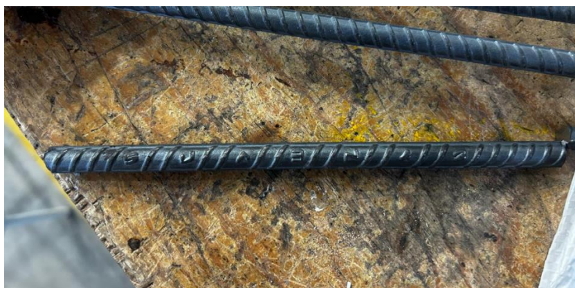
Figura 9. Varilla corrugada 3/8" grado 42. Fuente: elaboración propia.
