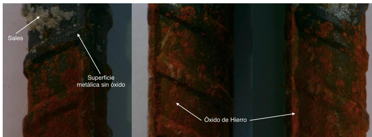
Figura 34. Varilla de acero corrugado con recubrimiento REC1 en el día 20 de exposición.
