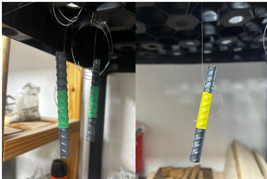
Figura 10. Especímenes de recubrimiento REC1 (color verde) y REC2 (color amarillo).
