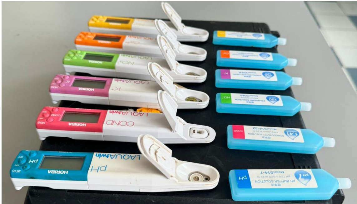
Figura 4. Unidades de medida HORIBA LAQUA twin del Kit Proain® para medir Sodio ( \text{Na}^+ (ppm)), Nitrógeno ( \text{NO}_3^- (ppm)) Potasio ( \text{K}^+ (ppm)) y Calcio ( \text{Ca}^{2+} (ppm)), Conductividad eléctrica (CE, \mu\text{S}/\text{cm} ) y Potencial Hidrogeno (pH): Imagen propia
