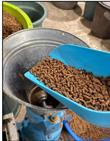
Figura 14. Reintroducción a la peletizadora para un segundo ciclo
