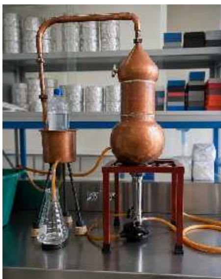
Figura 2. Alambique de cobre empleado para la extracción del aceite esencial
