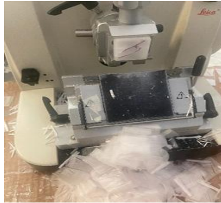
Figura 11. Obtención de cortes histológicos mediante el micrótopo rotatorio Leica RM2125RT.
