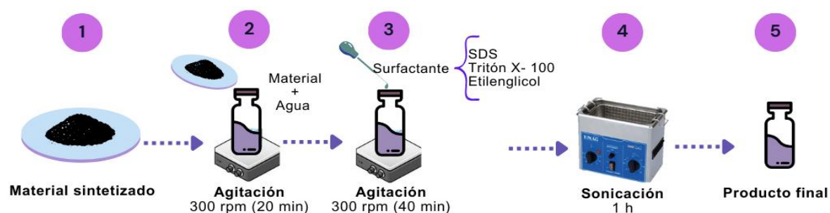
Figura 2.3. Formulación de tintas a partir del material bimetálico Cu–Ni sintetizado.
