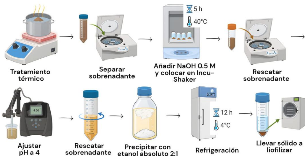
Figura 5. Metodología empleada para la extracción alcalina de arabinosilanos a partir de bagazo de cebada y su purificación.
