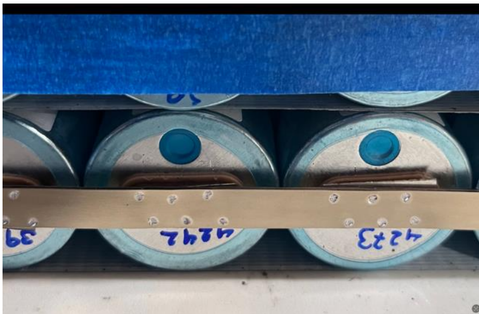
Ilustración 41: Soldadura de celdas después de la implementación de mejoras. Elaboración propia.
