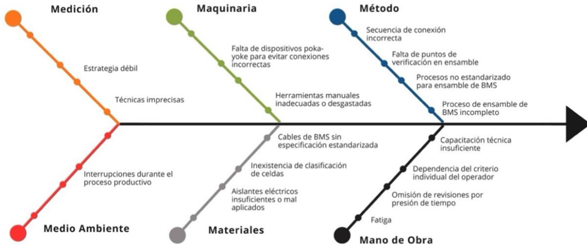
Ilustración 11: Diagrama Ishikawa de defectos en ensamble de baterías. Elaboración propia.
