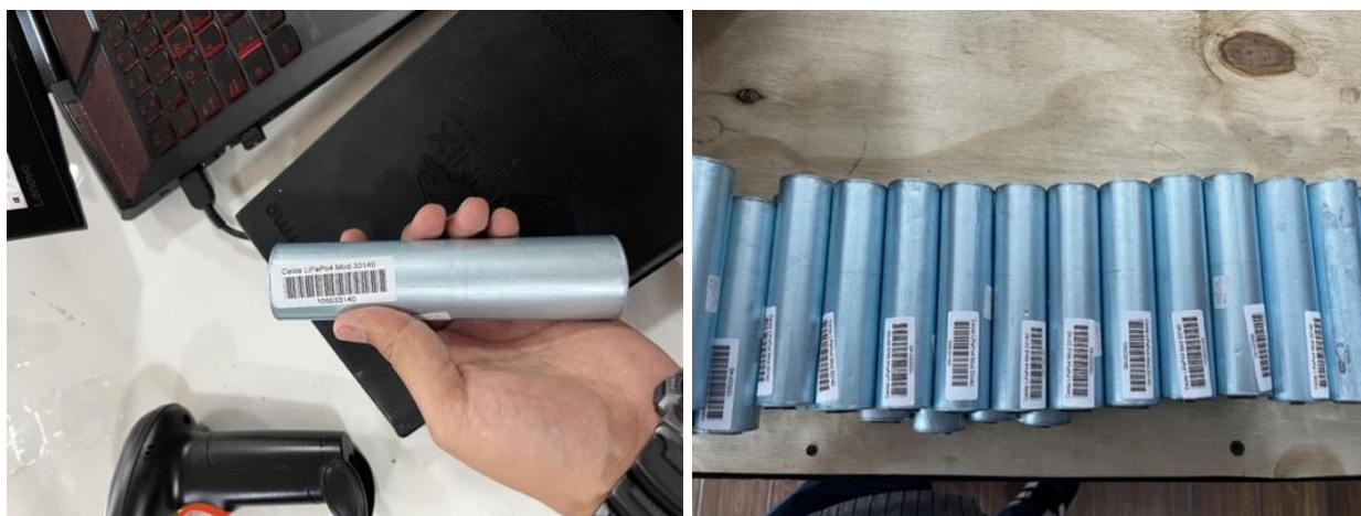
Ilustración 33: Implementación de codificación de celdas. Elaboración propia.
