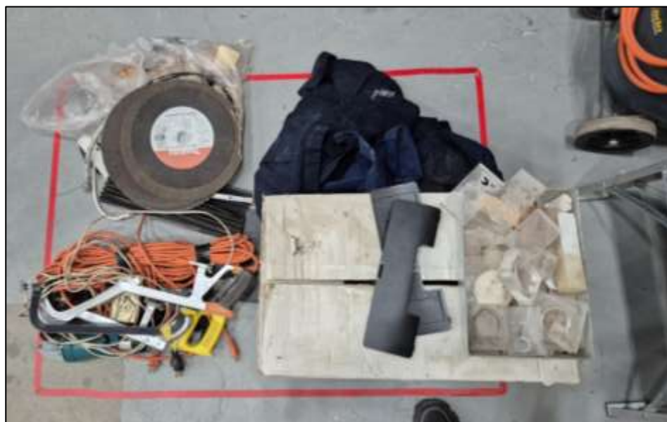
Figura 10. Herramental y equipos clasificados como no funcionales o inseguros durante la etapa de Seiri. (Fuente; autoría propia)
