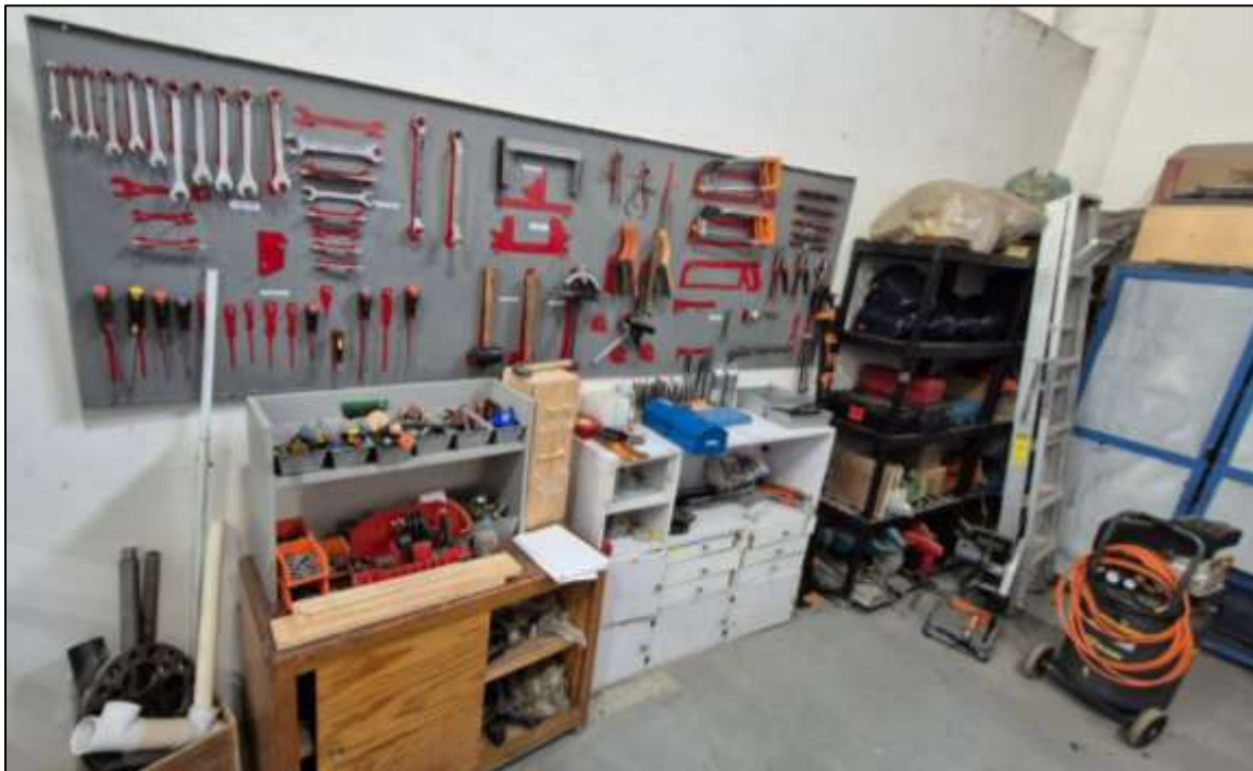
Figura 4. Estado inicial del panel de herramientas manuales. Se observa la colocación irregular del herramental y la ausencia de correspondencia con las siluetas existentes. (Fuente; autoría propia)
