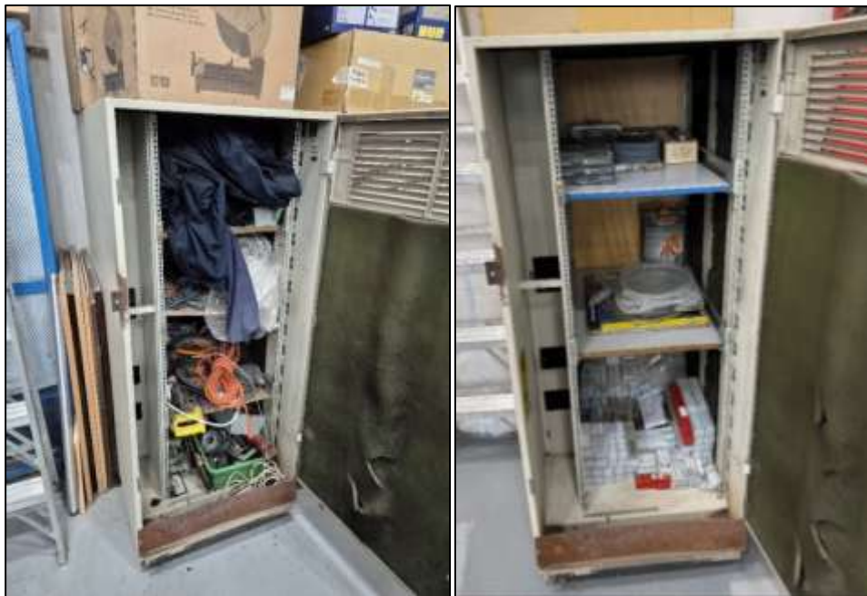
Figura 29. Estante 3 de repuestos nuevos antes y después de la implementación de la metodología 5'S. (Fuente; autoría propia)
