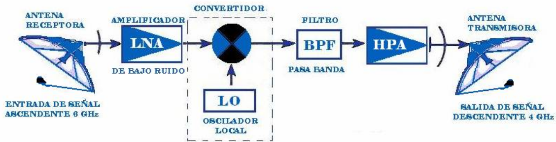
FIG. 1.9 DIAGRAMA DE BLOQUES DE UN TRANSPONDER DE COMUNICACIONES SATELITALES
