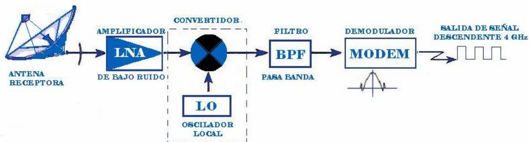
FIG. 1.10 ELEMENTOS PRINCIPALES DE UNA ESTACIÓN RECEPTORA
