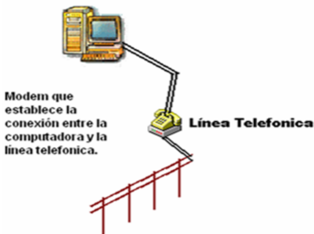
Figura 1.5 Una conexión a la Internet por medio de un módem y de una línea telefónica
