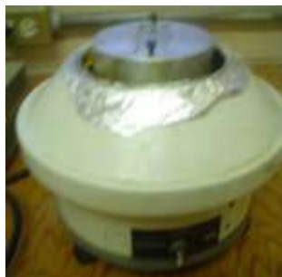
Figura 23. Equipo para la elaboración de nanopelículas por spin-coating.
