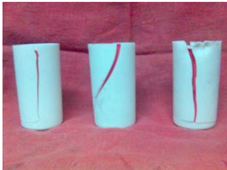
Figura 2. Crisoles de alumina, que sufrieron fractura en la sinterización en la muffle thermolyne 46000
