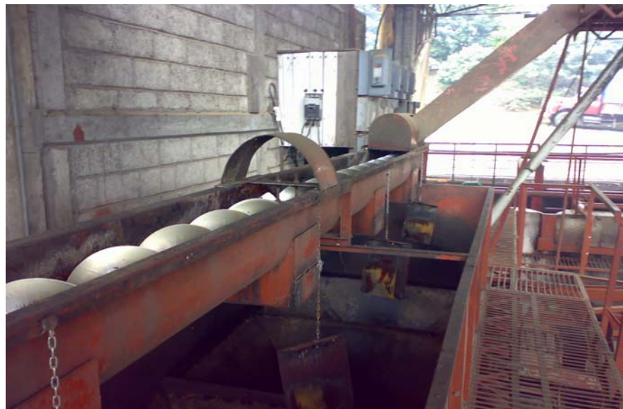
Figura 4.11 El café sube hasta estos cilindros posteriormente las compuertas se abren manualmente y el café cae hasta las secadoras.
