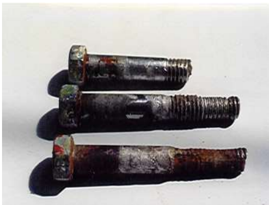
Fig. 27 Corrosión por socavados, la cual se aprecia en las cuerdas de los tornillos y alrededor de los barrenos de la pieza metálica.
