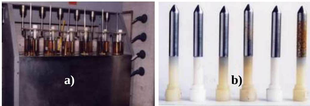
Figura 42. Método NACE TM para la evaluación de la corrosión. a) Equipo utilizado para la prueba de herrumbre, b) testigos de corrosión.
