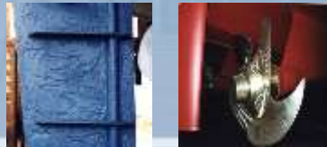
Timón de un barco sin PROTECCIÓN Hélice de un barco con PROTECCIÓN
