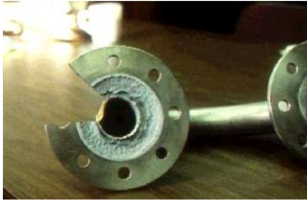
Fig. 31 Falla de un material por la corrosión por fatiga.
