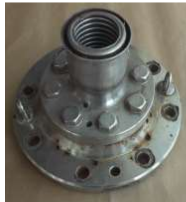
Fig. 27 Corrosión por socavados, la cual se aprecia en las cuerdas de los tornillos y alrededor de los barrenos de la pieza metálica.
