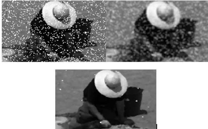
Figura 3 5 De arriba a abajo, imagen afectada en un 10% por el ruido de puntos blancos, filtrada con promedio y con mediana de radio 1 ó 3 x 3 píxeles (zoom al 200%).
