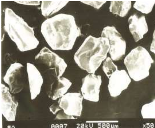
Fig. 2.5 Mezcla de población angular (más dominante) y granos de cuarzo sub-redondeados
