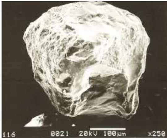
Fig. 2.1 Granos de cuarzo sub-redondeados mostrando cavidades grandes y medianas
