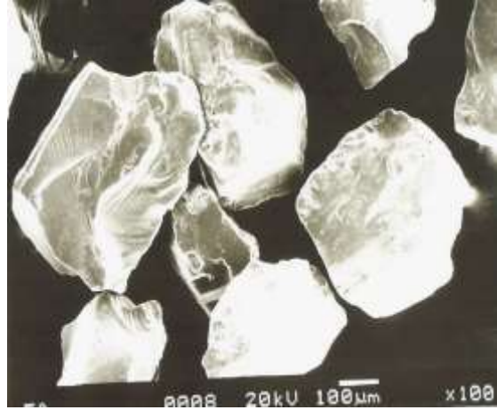
Fig. 2.12 Granos de Cuarzo muy angulares mostrando fracturas concoidales
