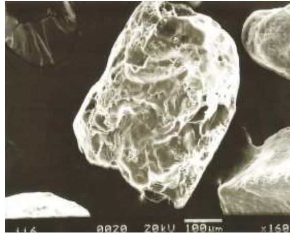
Fig. 2.22 Grano de Cuarzo con fisuras de solución y mostrando sobrecrecimiento cristalino
