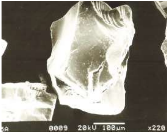
Fig. 2.13 Fracturas concoidales con pasos arqueados
