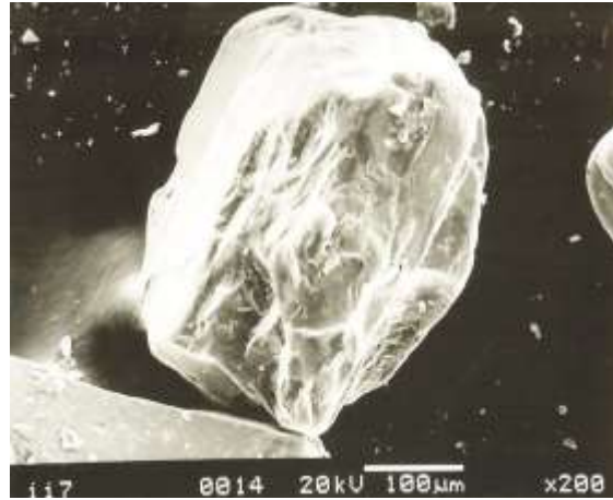
Fig. 2.16 Granos de Cuarzo sub-hedrales mostrando la fragmentación en la superficie del cristal y la forma crescent
