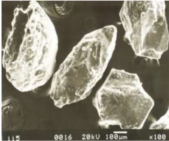
Fig. 2.21 Grano de cuarzo sub-hedral fragmentado mostrando fisuras de solución en la superficie
