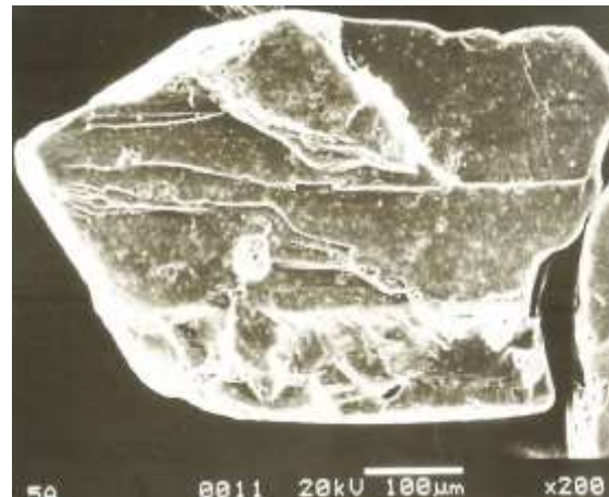
Fig. 2.18 Grano de cuarzo sub-hedral mostrando cavidades grabadas
