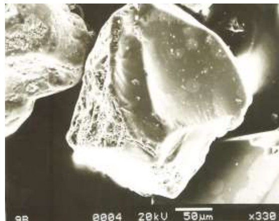
Fig. 2.10 Grano mostrando una fractura concoidal de gran tamaño (cavidad lenticular)
