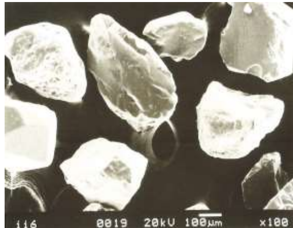
Fig. 2.2 Granos de cuarzo mostrando bordes curvos y cavidades
