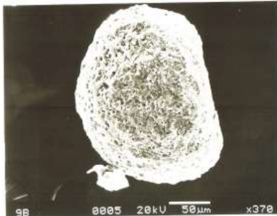
Fig. 2.4 Granos de cuarzo sub-redondeados con cavidades de medianas a pequeñas
