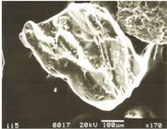
Fig. 2.14 Granos de cuarzo mostrando el desarrollo de estrías en la superficie
