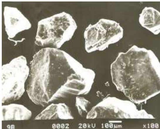
Fig. 2.9 Vista de cerca de la foto anterior, mostrando fractura concoidal de tamaño medio
