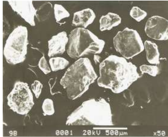
Fig. 2.8 Granos de cuarzo muy angulares y sub-angulares
