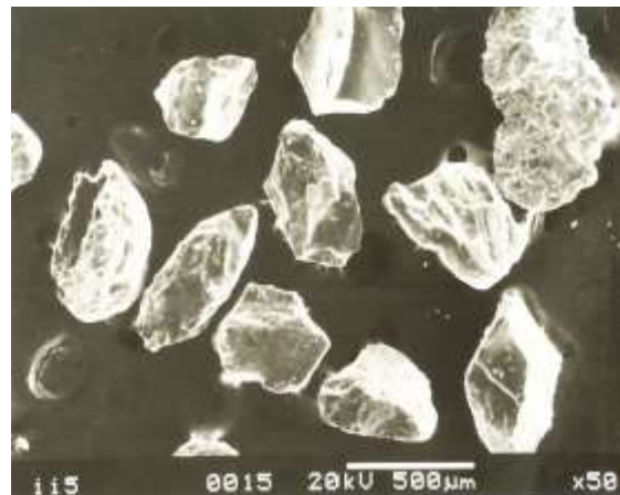
Fig. 2.6 Granos de cuarzo sub-hedrales y sub-redondeados
