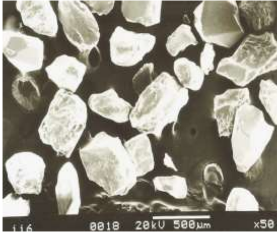
Fig. 2.11 Granos de Cuarzo angulares y sub-angulares mostrando fracturas concoidales
