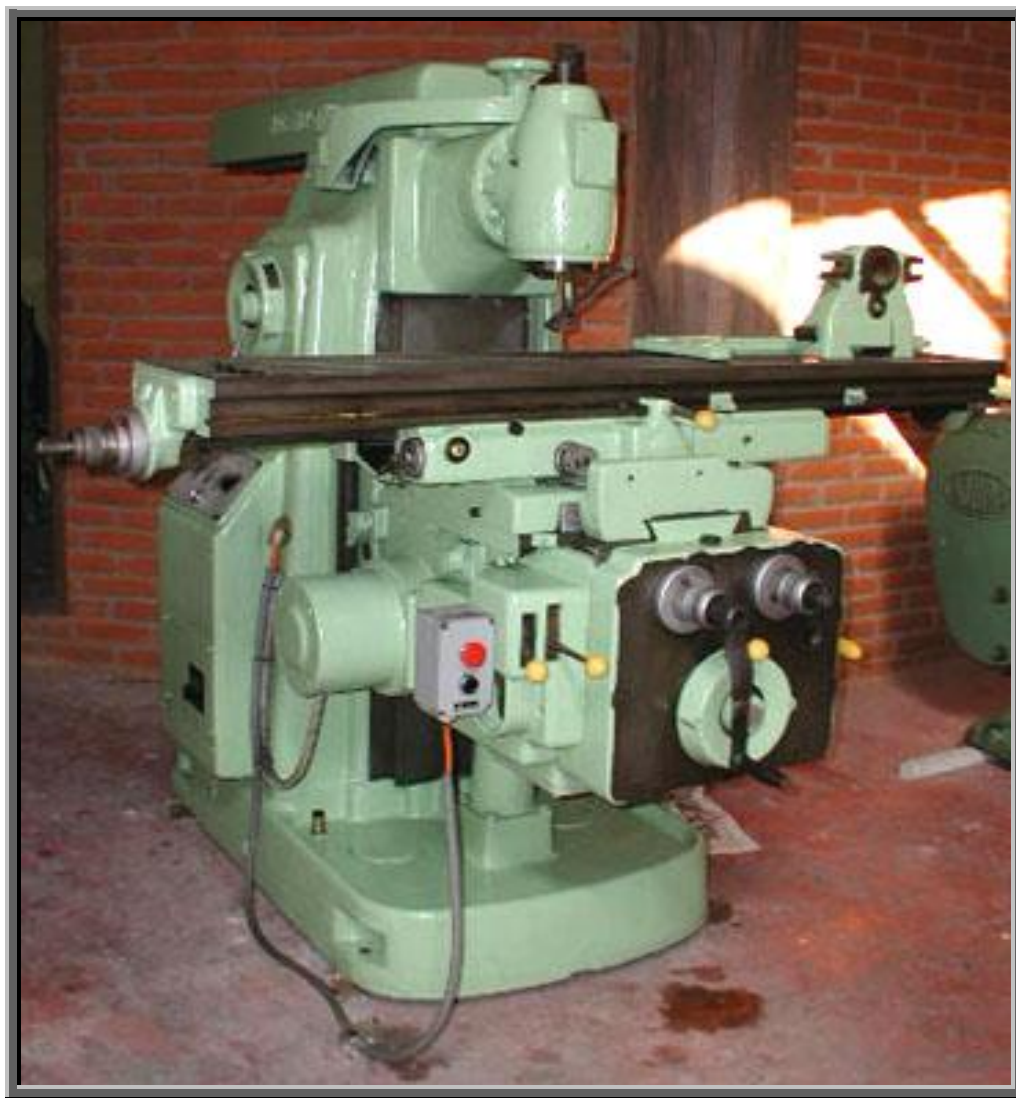
Fig. 6. Fresadora universal MAC-FAR 3S con soportes y barra 14"x 42" vertical y horizontal. 3
