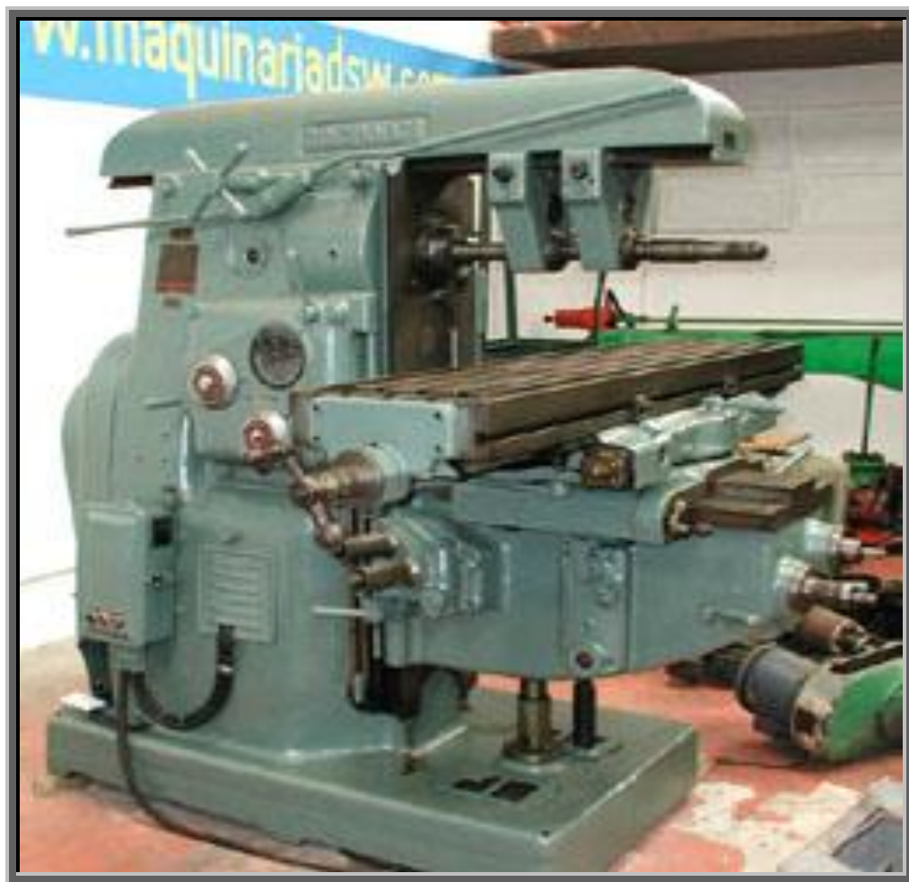
Fig. 4. Fresadora horizontal CINCINNATI, No. 4 12"x44" con cabezal vertical chico para adaptar. 10
