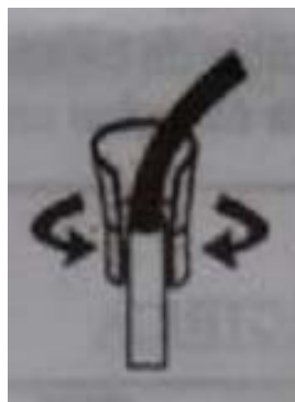
Figura 3.93. Colocar el Cono de Retención en el Conductor.
