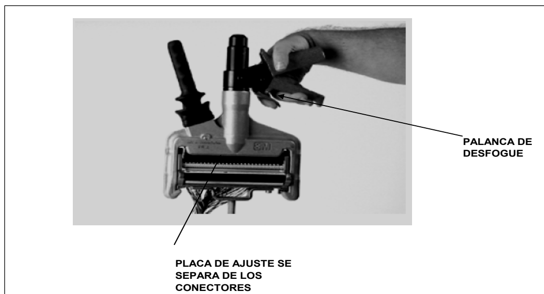
Figura 3.73. Operación de la Palanca de Desfogue.
