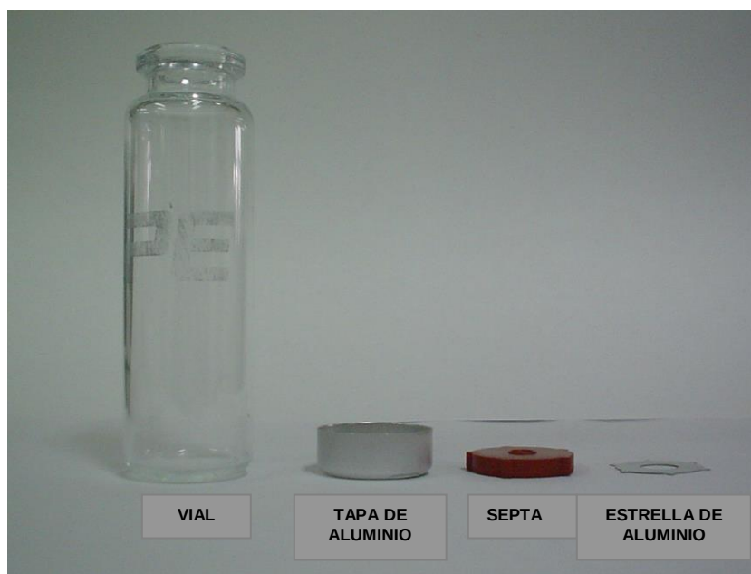
Figura 2. Material utilizado para el análisis de alcoholemia por medio de cromatografía de gases.
