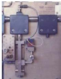
Figura 4.12: Amplificador paramétrico (Banda L).
