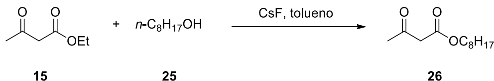
Esquema 13. Transesterificación de acetil acetato de etilo usando CsF como catalizador.
