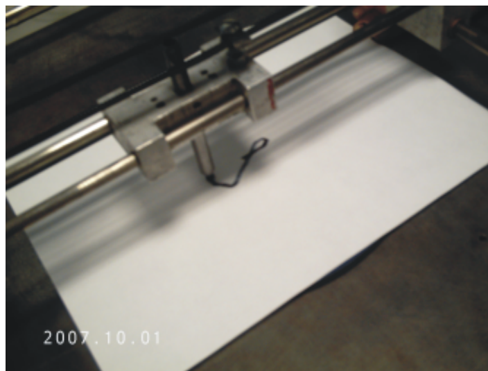
Figura 6.30: Reproducción de trayectoria de líneas curvas por el Robot Cartesiano
