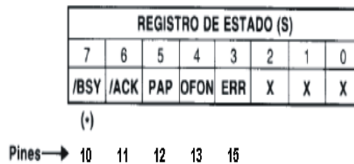
Figura B.3: Registro de estado y los pines correspondientes al conector DB-25.
