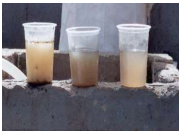
Figura 4. Agua residual previo a la entrada al reactor UASB la cual posteriormente, es filtrada por el filtro de arena-carbón activado.
