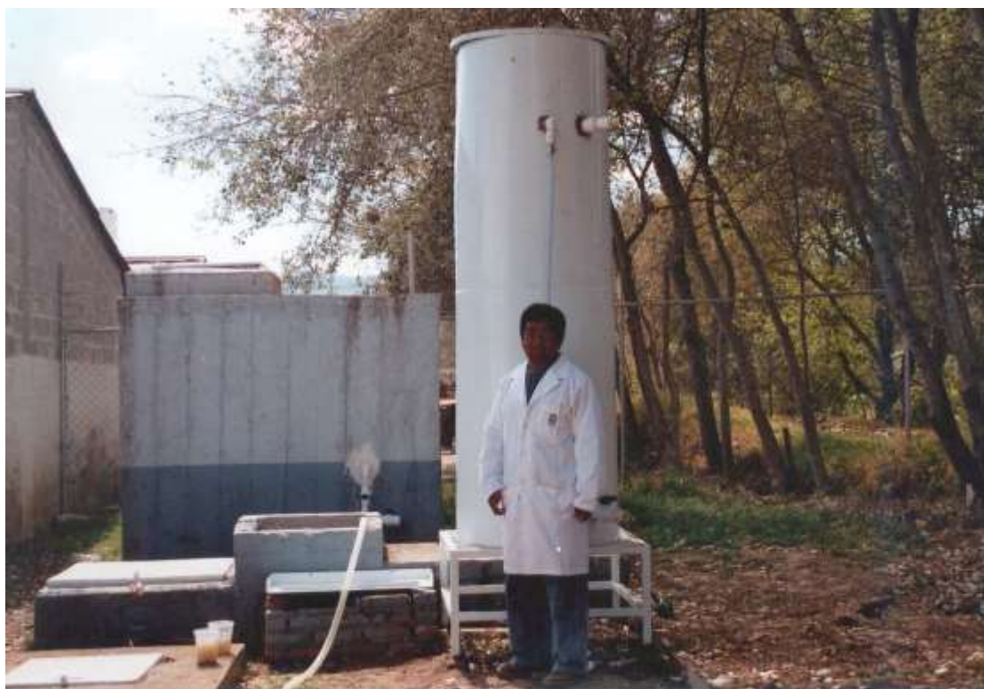
Figura 3. Planta piloto de tratamiento de aguas residuales con la adaptación de un filtro de arena-carbón activado
