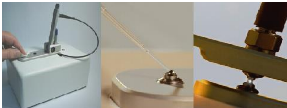
Figura 14. Determinación de la concentración y grado de pureza del ADN, en un NanoDrop® ND-1000 de UV/Vis.
