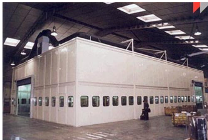
ILUSTRACIÓN 4.4 AISLAMIENTO DE PROCESOS PELIGROSOS.
