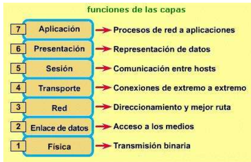
Fig. 8 Función de las capas del modelo OSI
