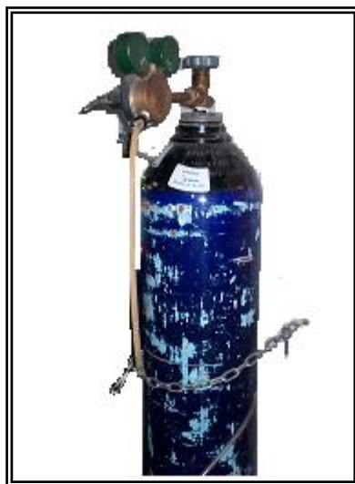
Figura 2.1 Tanque de Hidrógeno-Argón.
