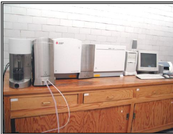
Figura 2.9 Analizador de tamaño de partícula ATP
