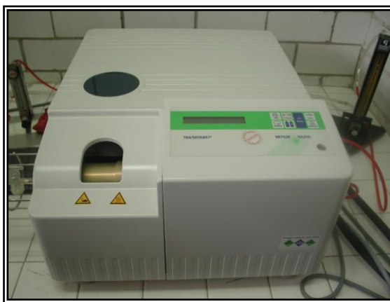
Figura 2.8 Analizador termogravimétrico TGA
