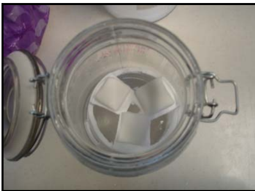
Frascos acondicionados para obtener la humedad relativa a determinada temperatura por medio del glicerol.
