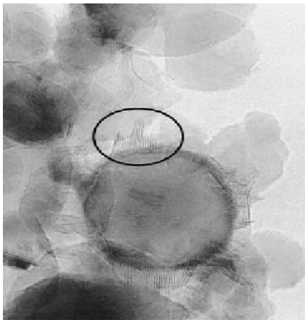
Figura I.5. Microfotografía obtenida por Microscopía electrónica de Transmisión (TEM Transmission electron microscopy ) de los Cúmulos de \text{MoS}_2 soportados en \text{TiO}_2 -Anatasa [21].
